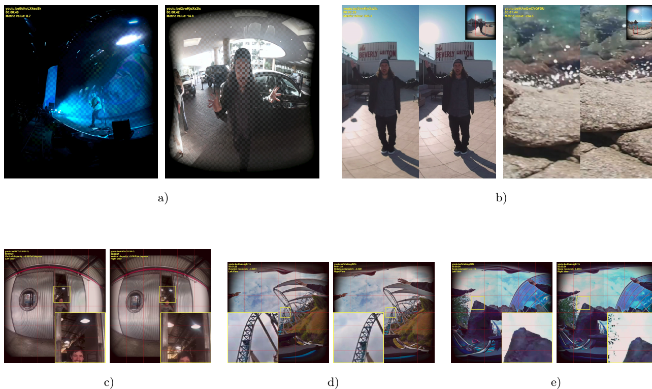
Рис. 8. Примеры найденных стереоскопических искажений в проанализированных видео в формате VR180: а) цветовые; б) резкости; в) поворот; д) масштабирование; е) вертикальный сдвиг
