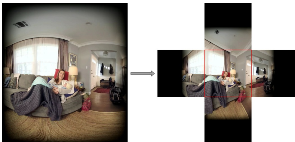
Рис. 2. Предобработка кадров видео в формате V180. Красным квадратом выделена фронтальная грань кубической проекции, непосредственно используемая при анализе качества VR180-видео
