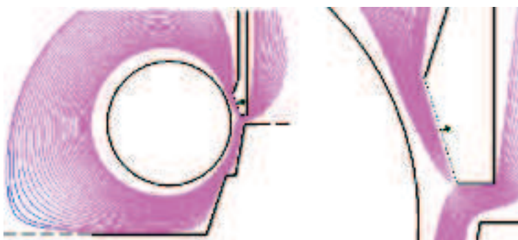
Рис. 3. Линии тока при вращении цилиндра с линейной скоростью v_{vr} = 0,5 м/с и v_0 = 0,5 м/с
