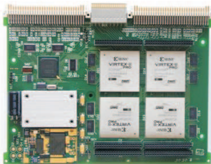
Рис. 5. Базовый модуль в конструктиве Евромеханика 6U
