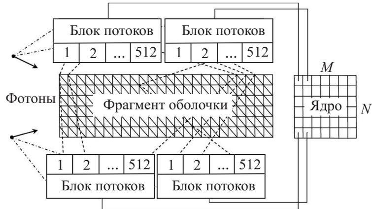
Рис. 4. Конфигурация ядра, выполняющего перевод вершин в локальные системы координат
