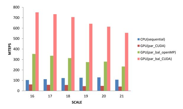
Рис. 3. Результаты измерений скорости обхода графов в ширину
